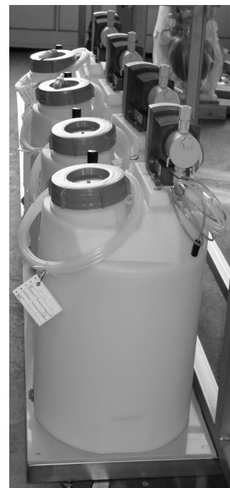
Рис.: дозировочные установки во время предварительного монтажа в нашей мастерской
